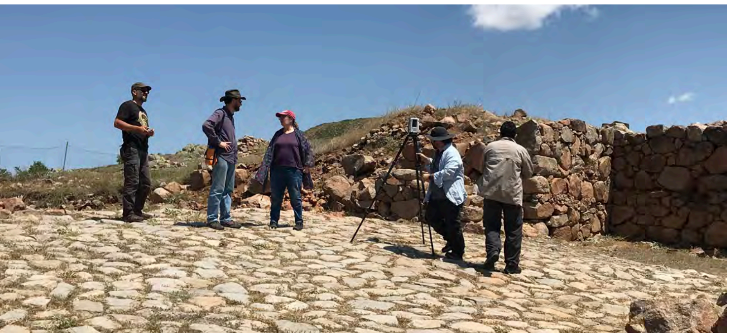
Restoration architects from Rekare Mimarlık preparing to scan the Cappadocia Gate with a Leica RTC360 terrestrial laser scanner. Rekare Mimarlık şirketinin restorator mimarları, Kapadokya Kapısı'nın belgelenmesi için Leica RTC360 yersel lazer tarama cihazını kuruyor.
